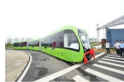
Tram sur pneu sans rails ni chauffeur, 70 km/h, sur batteries, Chine, 2017
